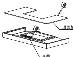
在机体上部（如图）先用螺丝刀将顶盖板螺丝拧开，取下顶盖板，再用螺丝刀将开关螺丝拧开，取下开关。
