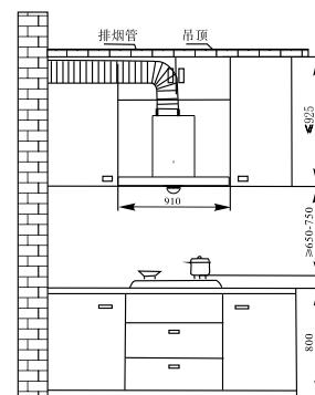
出风管走吊顶安装示意图
