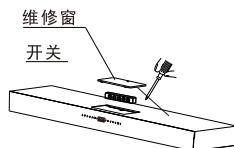
在机体上部（如图）先用螺丝刀将维修窗螺丝拧开，取下维修窗，再用螺丝刀将开关螺丝拧开，取下开关。
