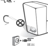
●移动冰箱时:移动冰箱前取出冰箱内所有物品,用胶带将玻璃搁板、果菜盒、制冰盒、冷冻室抽屉等固定好;关紧冰箱门、用胶带固定,以免移动时门打开。搬动时请勿倒置、横放、挤压、震动冰箱,倾斜角度不可大于45°。
