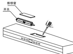
在机体上部(如图)先用螺丝刀将维修窗螺丝拧开，
