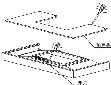
在机体上部(如图)先用螺丝刀将顶盖板螺丝拧开，
