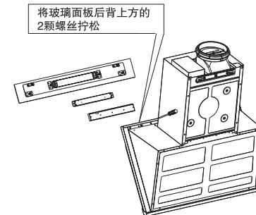
拧下玻璃钢面板后背上方的3颗螺丝，直接取下玻璃面板，然后取下开关压板，拧开开关两边螺丝，更换开关。
