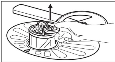
2. 拆下过滤器 (B) 中的过滤器 (C)。
