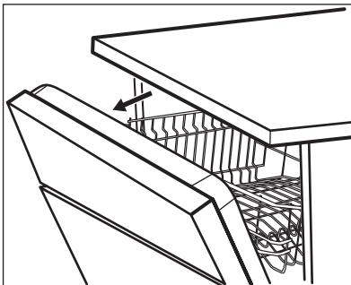
AirDry ( 空气对流干燥 ) 与所有程序一起自动启动，但预冲洗除外。
