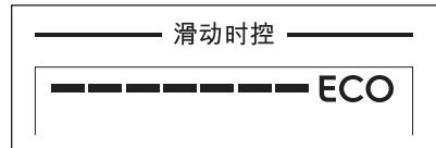
节能程度 显示程序选择如何影响能耗和用水量。条状亮起越多，能耗越低。
