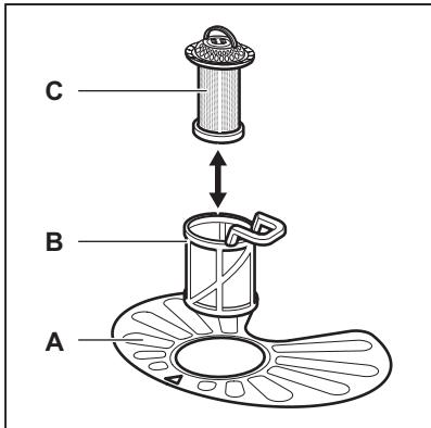
1. 逆时针旋转过滤器 (B)，将其拆下。
