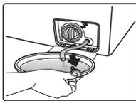
将紧急排水管从固定处取出，拔出紧急排水管塞子，将残留的水排出，排水结束后装回塞子；
