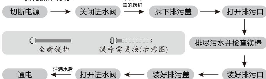
**排空热水器：**电热水器在长期停用或维修时，可切断电源，关闭进水截止阀，开启一个出水截止阀，然后掀起安全阀的手柄把内胆中的水排空。重新使用时，必须将热水器内胆注满水后才能接通电源工作。
