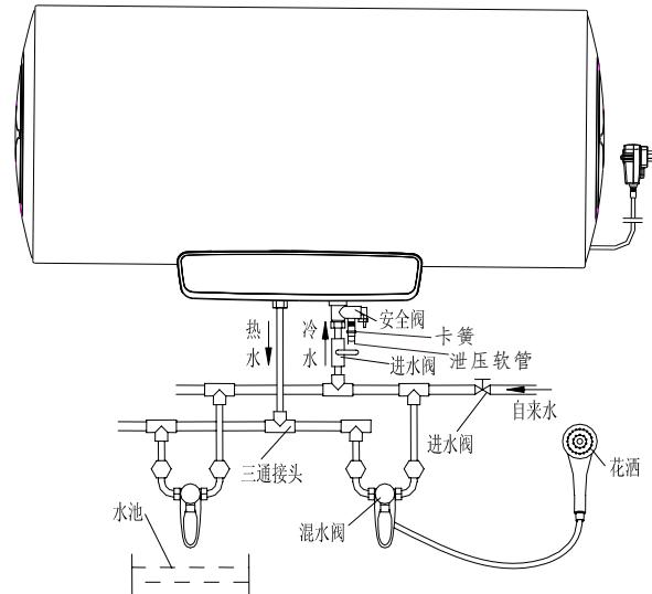
注：以上安装实例中，除安全阀、泄压软管、卡簧为随机配送外，其它部件由用户根据需要自行购买，卡簧用于固定泄压软管。
