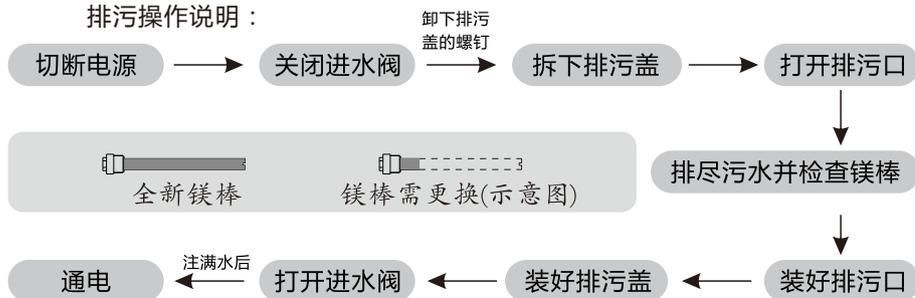
放空热水器：电热水器在长期停用或维修时，可切断电源，关闭进水截止阀，开启一个出水截止阀，然后掀起安全阀的手柄把内胆中的水排空。重新使用时，必须将热水器内胆注满水后才能接通电源工作。
